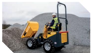
**WACKER NEUSON • Dumper électrique DW15e** - Sans émission grâce à sa motorisation électrique, tout en offrant les mêmes performances que le modèle conventionnel thermique. La motorisation électrique fait de cette machine l'engin idéal pour la manutention de matériaux, partout où les émissions de gaz d'échappement ou le bruit ne sont pas souhaités ou autorisés.
